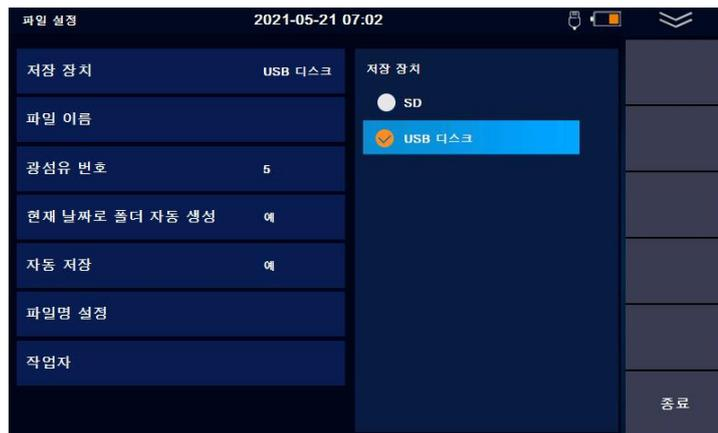
(ㄴ) 어떤 방법으로: 저장하는 방법은 크게 자동저장과 수동저장 두 가지가 있습니다. OTDR의 종류에 따라 두 가지를 다 지원할 수도 있고, 혹은 수동 저장만 지원할 수도 있습니다. 저장 전 저장시킬 결과 파일의 종류(SOR 혹은 ET)를 정하고, 파일명의 형태(예를들면 프로젝트명+자동순번)를 설정할 수 있습니다.
